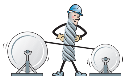
Figure 2-5 – ne pas créer de torsion inverse Figure 2-6 - Installation du câble sous tension, environ 10% de la traction nominale du câble
